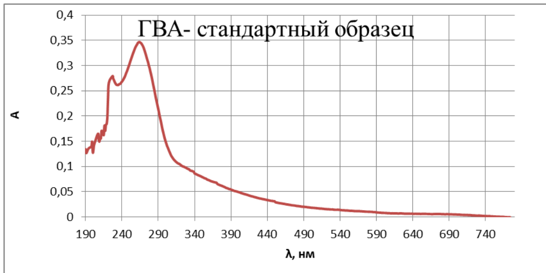
Рисунок 29 - Спектр поглощения 0,001% раствора ГВА - стандартного образца в УФ- и видимой областях
